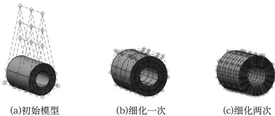
图1 圆筒几何模型图
