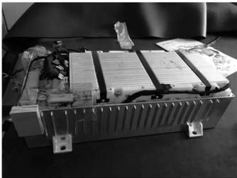
图5 钛酸锂电池模组实物图
